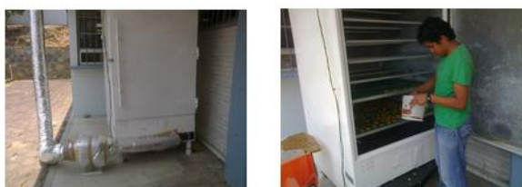
Figura 5 Cámara de secado y aislamiento del colector solar.
