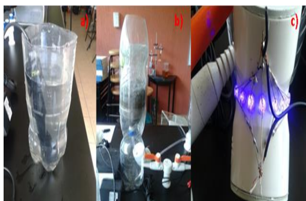
Figura 1 Proceso de tratamiento del agua del río Taxco, donde; a) muestra del agua del río Taxco, b) filtro de clorita, y c) luz Ultravioleta
