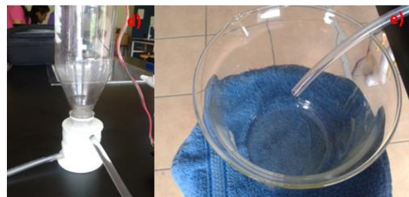
Figura 2 Proceso del tratamiento del agua del río Taxco. d) Oxigenación a través del efecto Venturi, y e) envase colector final (agua filtrada).
