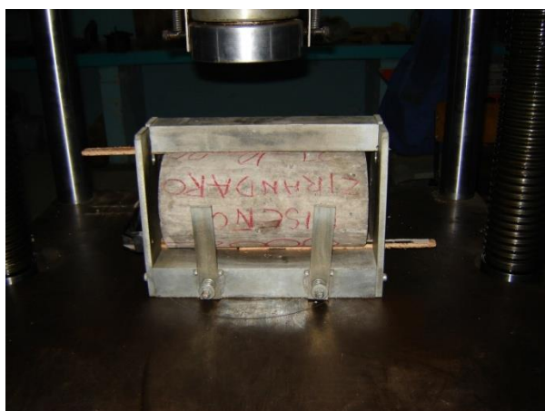
Figura 3 Ensayo de tensión por compresión diametral.
